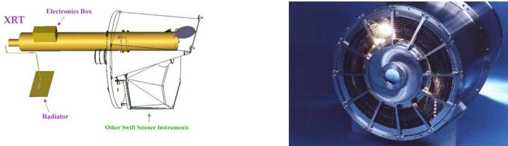
図 2.2: X-Ray Telescope : 鏡筒とミラー (NASA/GSFC)
